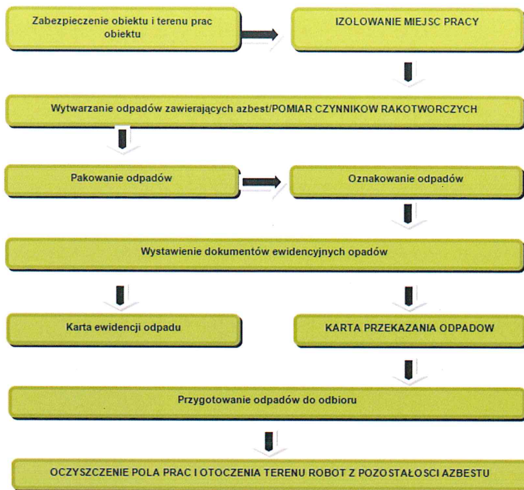
Rysunek 10. Schemat procedury dotyczącej prac polegających na usuwaniu wyrobów zawierających azbest, wytwarzania odpadów niebezpiecznych wraz z oczyszczaniem obiektu/terenu/instalacji
